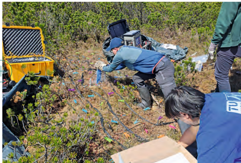
Messanlage TU Wien & Vorbereiten des Freeze-Cores mit Trockeneis
